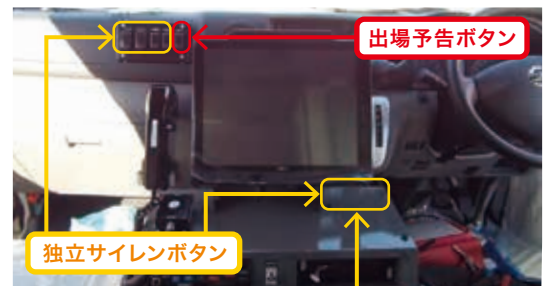
(写真1) 出場予告ボタンや独立サイレンボタンの設置状況
