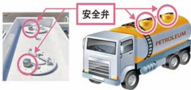
危険物を搬送するタンクローリーは、消防法により1年に1回以上定期点検を行い、その記録を3年間保存しなければならないとされています。そして、点検項目のひとつとされる安全弁は、定められた試験装置により作動試験を行う必要があります。
